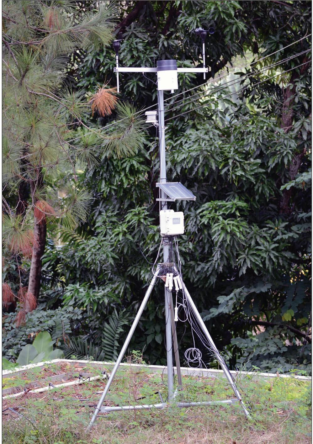
Figura 38—Una de dos estaciones de clima Campbell en los techos verdes. Estas estaciones monitorizan la temperatura y humedad del aire, la velocidad del viento, incidencia de energía y la lluvia.
