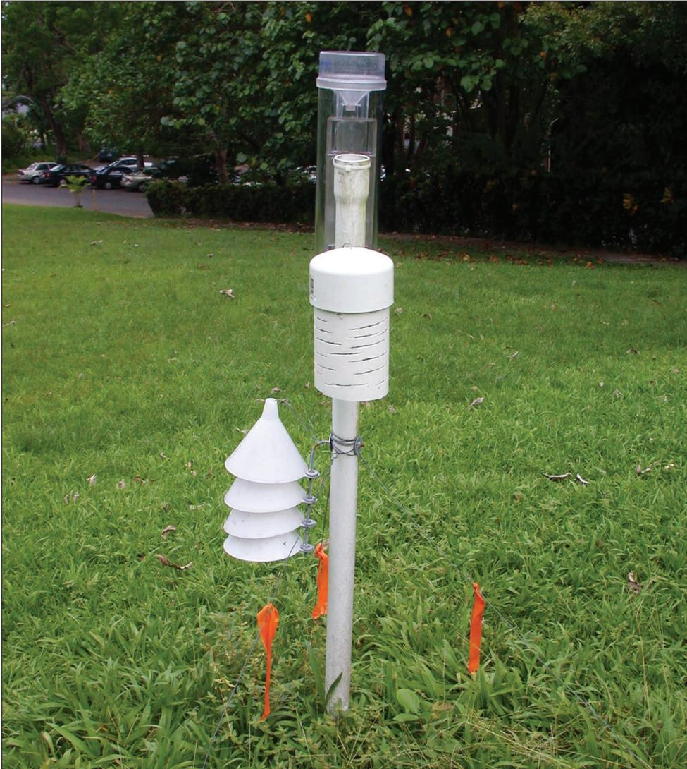
Figura 39—Sensores de datos climatológicos (temperatura y lluvia) son partes de la estación de clima frente al Edificio del Instituto operado por el Instituto.
