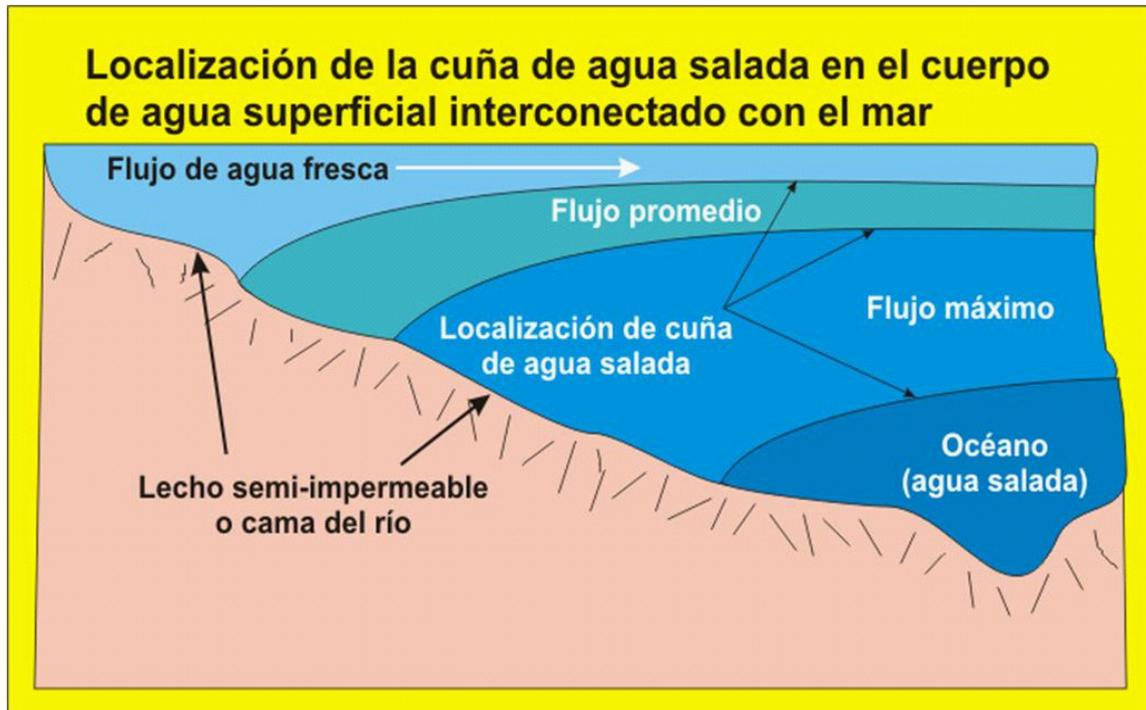
dulce, la cuña de agua de mar puede penetrar por el cauce del río varios kilómetros tierra adentro. Con las lluvias intensas, los ríos aumentan sus descargas y empujan la cuña de agua salada al mar. Durante sequías, hay menos descarga de agua fresca y la cuña avanza tierra adentro.
