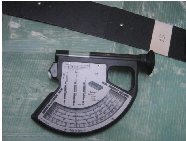
Ilust. 24 Determinación de la altura (h) de los árboles mediante el uso del altímetro dependiendo del declive del terreno
